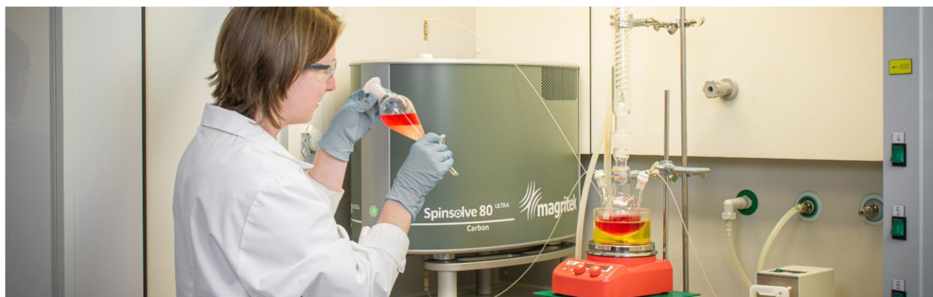
図 1. 化学実験室で製品の迅速な分析に利用されている Spinsolve NMR 分光法。サンプルに含まれる典型的なプロトン化した溶媒が試料中に存在するため溶媒抑制法やカーボンデカップリング法を用いて目的の分析対象物のスペクトルを取得する必要がある。
